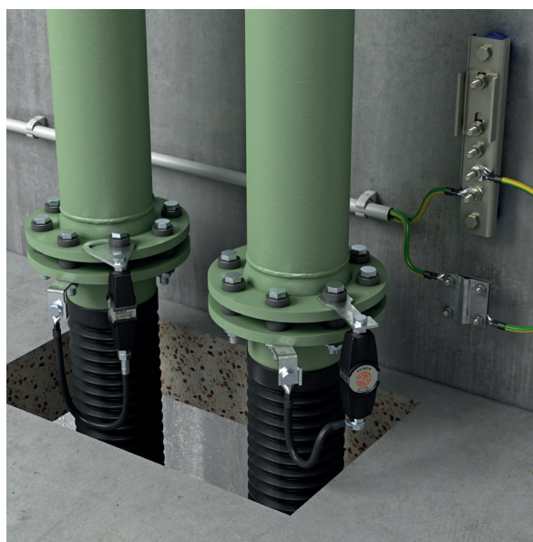
Abb. 4: Montaż iskiernika do elementów izolowanych
